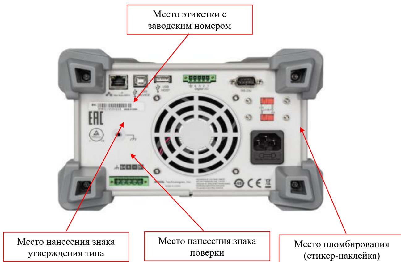
Рисунок 2 - Задняя панель источников модификаций DP811/DP811A, DP813/DP813A
